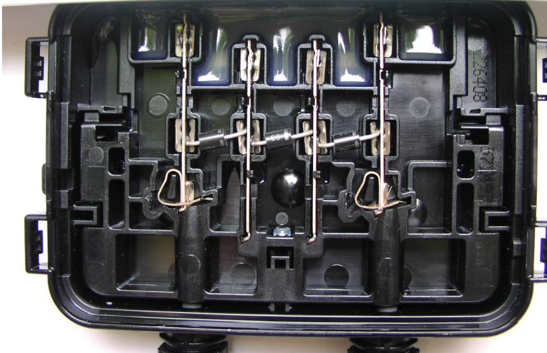
Bild 7: Anschlusskasten Picture 7: junction box
