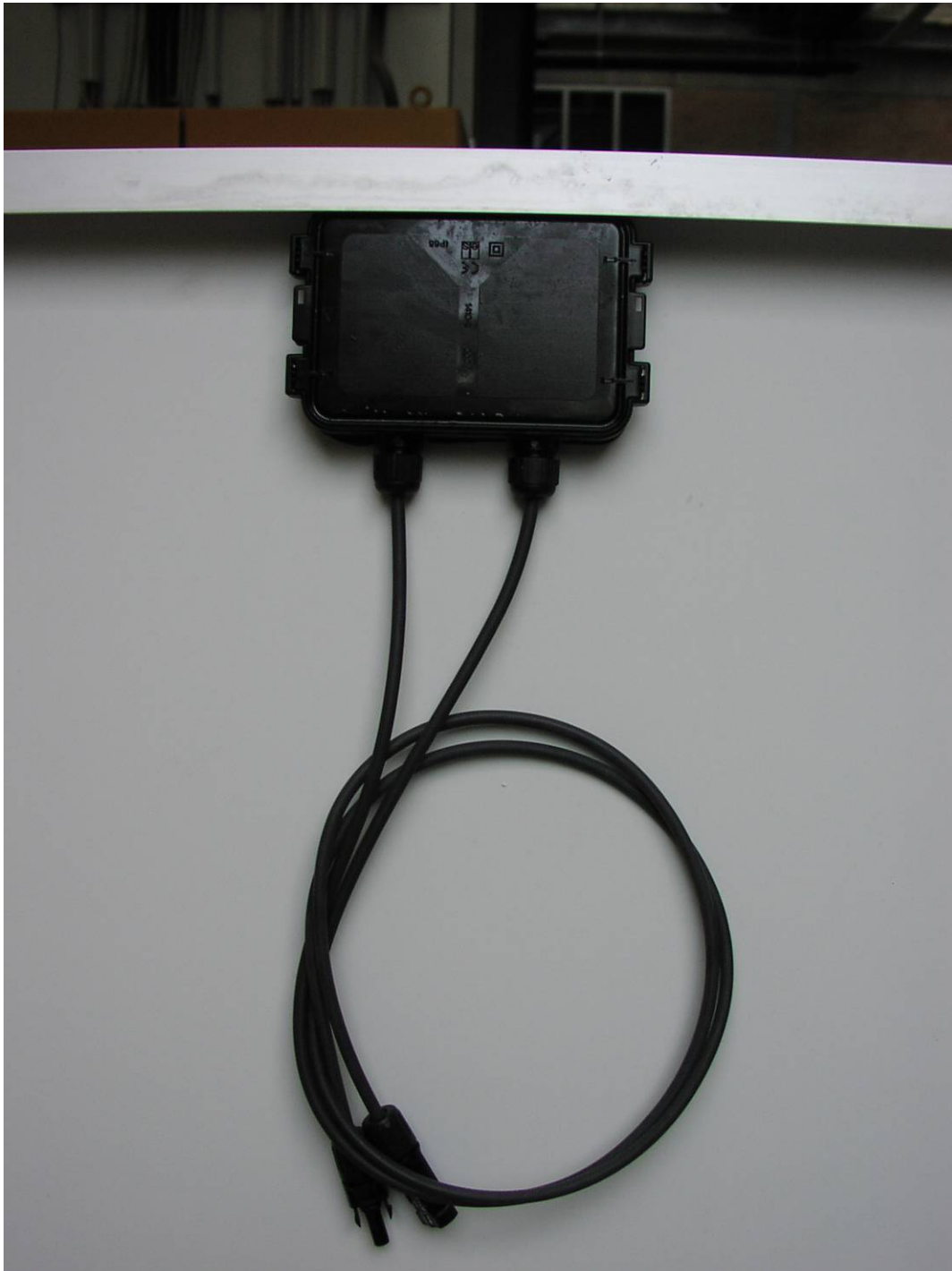
Bild 6: Anschlusskasten Picture 6: junction box
