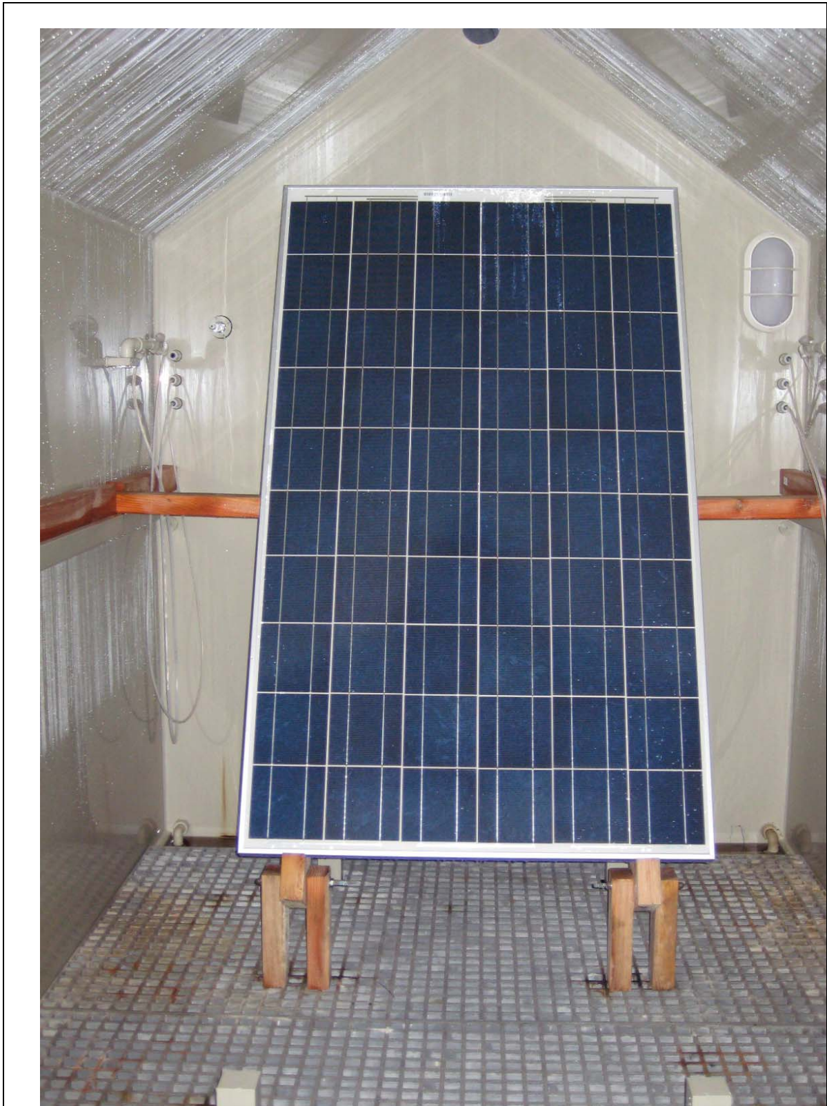
Bild 8: Anordnung PV Modul in der Korrosionskammer Picture 8: Set-up of PV module in corrosion chamber
