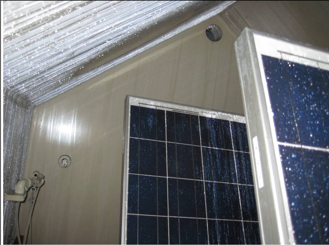
Bild 9: Anordnung PV Modul in der Korrosionskammer (hinteres Modul)
