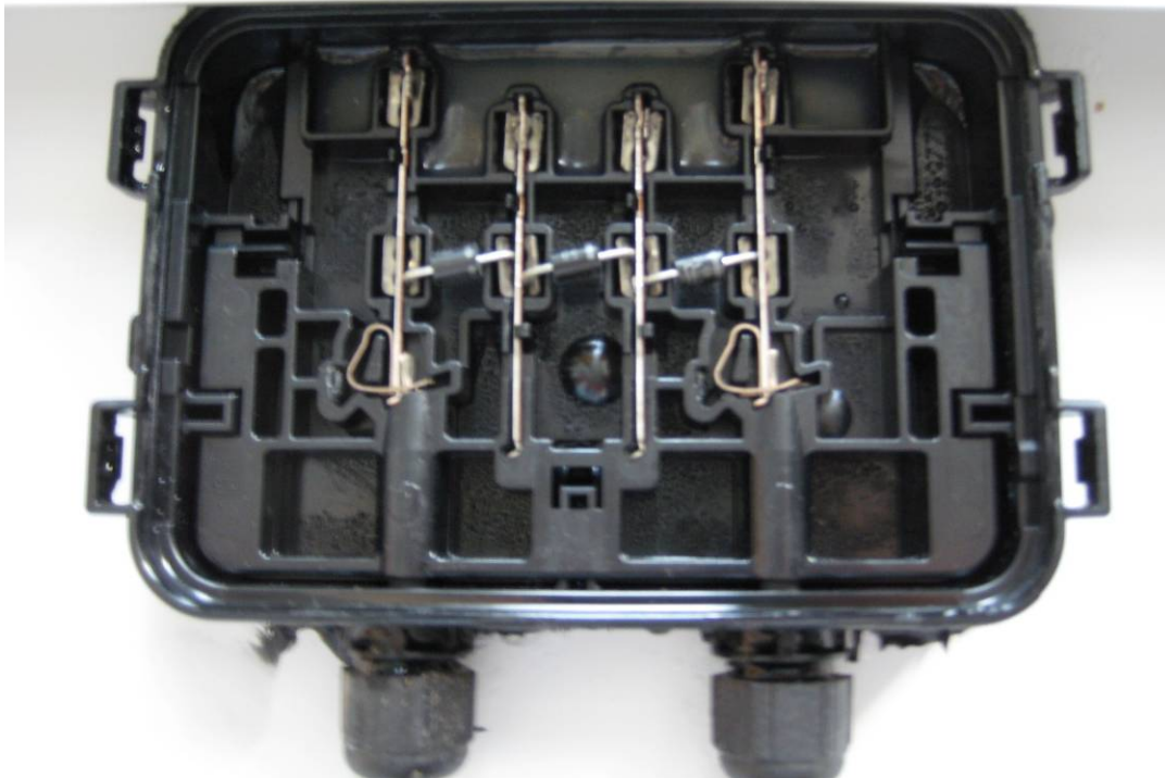
Bild 11: Anschlusskasten Picture 11: junction box
